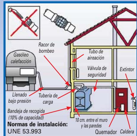
Tanto la instalación de un tanque como la de una batería de tanques deben realizarse conforme a la Norma de instalación UNE 53.993 y han de seguir las instrucciones técnicas recogidas en el reglamento de la "IP-03" que regula las "Instalaciones petrolíferas para uso propio".
